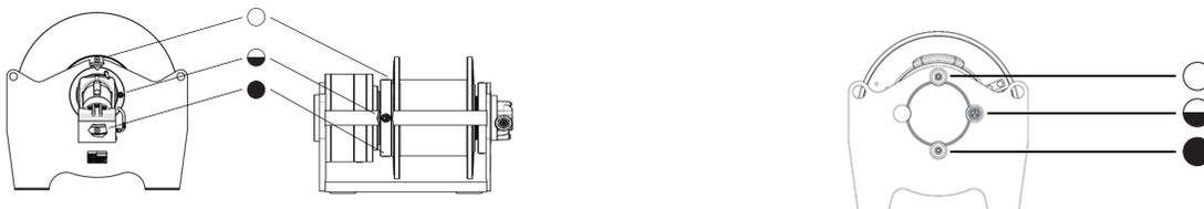
Je nach Winden-Endmontageposition ändern sich die Steckerposition entsprechend. Die verfügbare Position wird oben dargestellt und hängt von der Größe der Winde ab.
