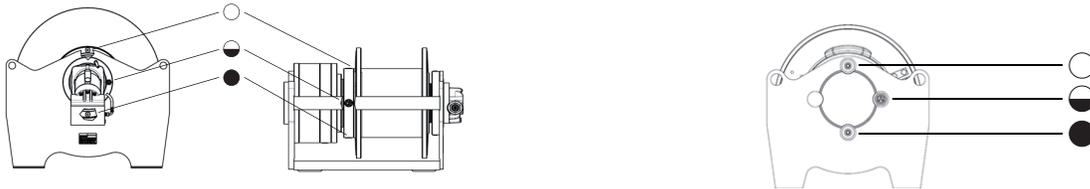
La position des bouchons varie en fonction de la position finale de montage du treuil. Les positions disponibles sont représentées ci-dessus et dépendent de la taille du treuil.
