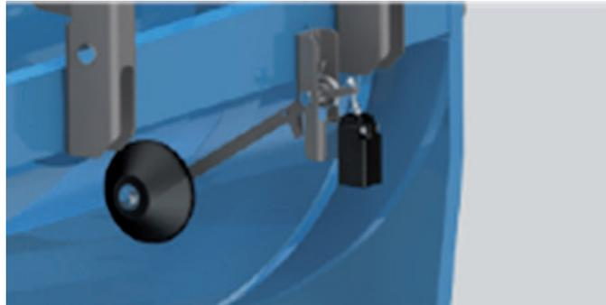
Le micro-interrupteur magnétique est équipé d'un bloc de contacts à déclenchement instantané normalement ouvert NO + un autre normalement fermé NC. Le circuit NC doit être utilisé pour le circuit de sécurité et le signal électrique provenant du micro-interrupteur doit être utilisé de manière appropriée par l'installateur pour arrêter la machine en toute sécurité.
