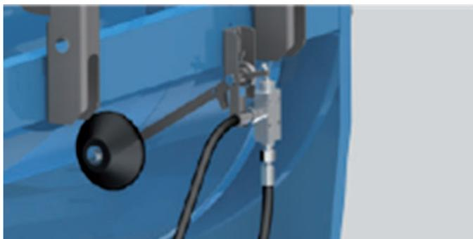
O microinterruptor hidráulico (1) é uma válvula normalmente fechada que permite que um sinal de pressão, vindo do motor, abra o travão e comande a válvula central ao elevar ou baixar.
