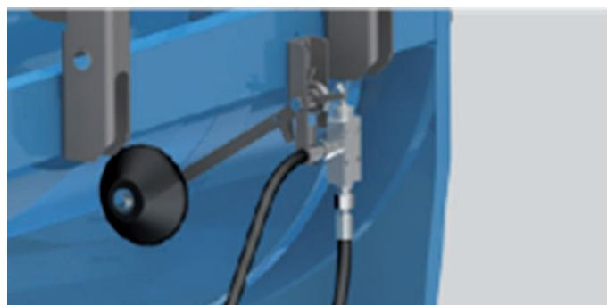
Hidraulički mikroprekidač (1) normalno je zatvoren ventil koji omogućuje da signal tlaka koji dolazi iz motora otvara kočnicu i pokreće nadcentralni ventil tijekom dizanja i spuštanja.
