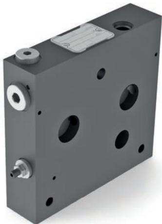
L'interfaccia HSIF consente il collegamento idraulico tra elementi del distributore proporzionale HPV77 con elementi dei distributori proporzionali CXDH3 / CX3 o dei distributori on/off CDH3 / CD3 / CDC3.
