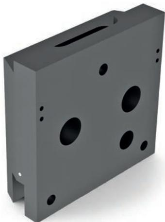
HSEF è una interfaccia che consente il collegamento idraulico tra elementi del distributore proporzionale HPV 77 con elementi del distributore proporzionale HPV 41 quando è presente la sezione di entrata intermedia HFLS nella parte dell'HPV77. Il modulo HSEF deve essere inserito nella composizione del distributore tra l'ultimo elemento HPV77 e il primo elemento HPV41.
