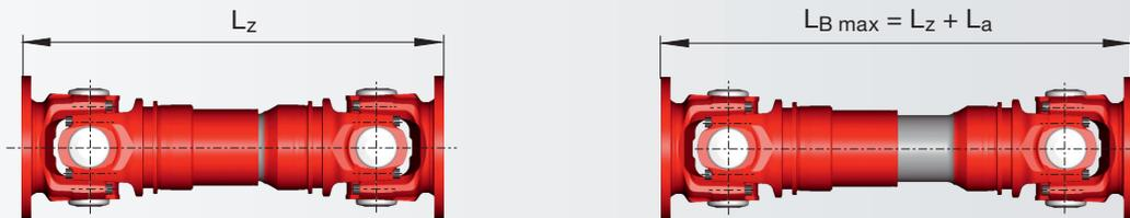
Die Gelenkwelle darf im Betrieb bis zu dieser Länge ausgezogen werden. Die günstigste Betriebslänge  $L_B$  einer Gelenkwelle ist dann erreicht, wenn der Längenausgleich mit einem Drittel seiner Länge ausgezogen ist.
