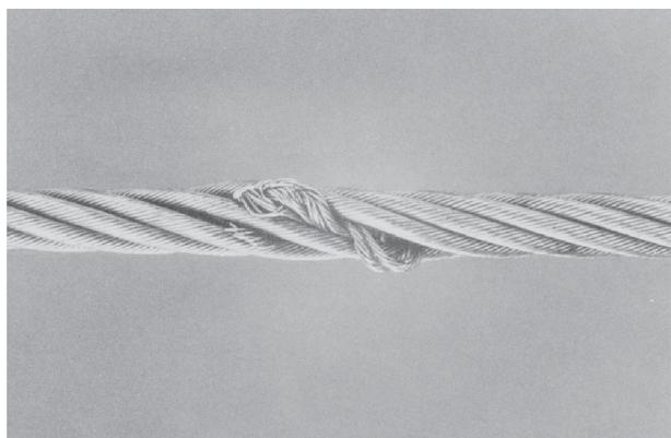
**FIGURE 2:** Espulsione di trefoli
