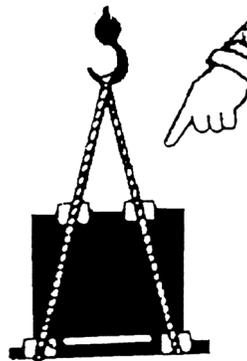
Werden die Frachtstücke mit einem Flaschenzug und auf jeden Fall an einem Haken abgeladen, muss das Gewicht gleichmäßig verteilt sein. Beim Anheben durch Seile oder Gurte normgerechtes Hubzeug verwenden. Bei Versand auf Palette sind die Hubmittel mit größter Vorsicht anzuwenden, damit sie das Gerät nicht beschädigen.
