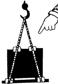
Si los bultos se descargan con un cabestrante o un gancho, asegurarse de que la carga esté equilibrada y, al atarla, utilizar accesorios para la elevación homologados según la ley. En caso de productos enviados con paletas, hay que prestar mucha atención para que los accesorios de elevación no los dañen
