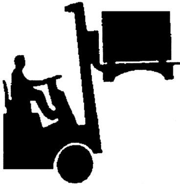
Si los bultos se descargan con una carretilla elevadora, asegurarse de que el peso quede centrado en las horquillas.
