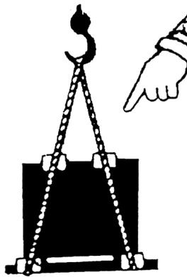
Si les colis sont déchargés par un palan ou par un crochet vérifier que la charge soit équilibrée. Armer l'élingue de dispositifs de levage homologués aux normes. Pour les colis expédiés sur des palettes faire attention que les accessoires de levage n'endommagent pas la machine.
