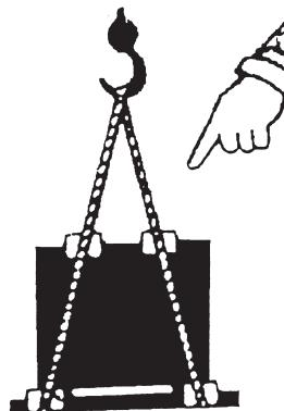
Werden die Frachtstücke mit einem Flaschenzug und auf jeden Fall an einem Haken abgeladen, muss das Gewicht gleichmäßig verteilt sein. Beim Anheben durch Seile oder Gurte normgerechtes Hubzeug verwenden. Bei Versand auf Palette sind die Hubmittel mit größter Vorsicht anzuwenden, damit sie das Gerät nicht beschädigen.
