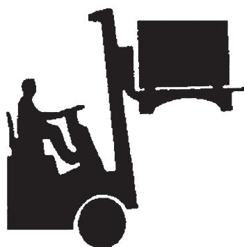
Bei Verwendung eines Gabelstaplers muss das Gewicht gleichmäßig auf den Gabeln verteilt sein.
