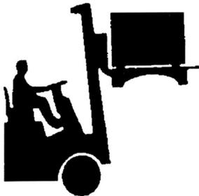
Beim Abladen der Packstücke mit einem Gabelstapler darauf achten, dass das Gewicht gleichmäßig auf den Gabelzinken verteilt ist.
