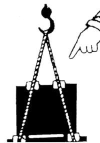
Beim Abladen der Packstücke mit einem Kettenzug oder Lastraken sicherstellen, dass die Last im Gleichgewicht hängt. Ausschließlich geprüfte Anschlagmittel verwenden. Bei Packstücken auf Paletten darauf achten, dass die Anschlagmittel nicht die Maschine beschädigen.
