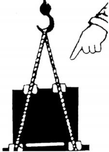
Si los bultos se descargan con un polipasto y, en todo caso, con un gancho, asegurarse de que la carga esté equilibrada y en las eslingas utilizar accesorios para la elevación homologados y que cumplan la ley. Para los bultos enviados en palets, asegurarse de que los accesorios de elevación no dañen los productos.
