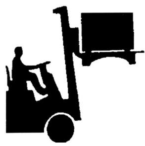
Se i colli vengono scaricati da un carrello elevatore assicurarsi che il peso sia bilanciato anche sulle forche.
