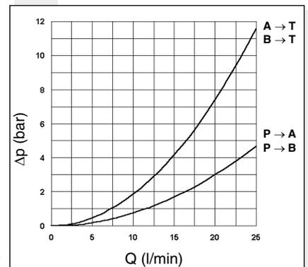
Prove eseguite con olio minerale alla temperatura di 40°C con viscosità di 46 mm<sup>2</sup>/s.
