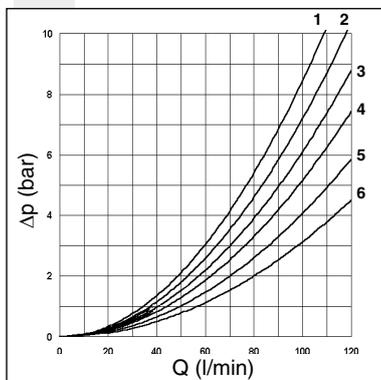
Nel diagramma a fianco sono rappresentate le curve delle perdite di carico per i cursori di normale impiego.
