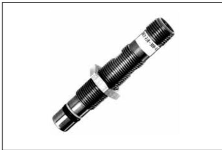
I sensori di prossimità induttivi consentono il rilevamento di oggetti metallici; il principio di funzionamento è basato su un oscillatore ad alta frequenza che produce un campo elettromagnetico nelle immediate vicinanze del sensore.
