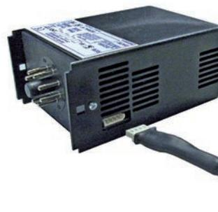
Collegamento REM al computer tramite cavetto seriale.
