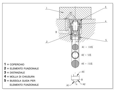
L'elemento logico opera in funzione delle pressioni agenti sulle aree utili ed in funzione delle dimensioni di queste aree vengono ottenute diverse pressioni di apertura.
