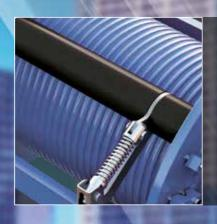
PRESSURE ROLLER TO AVOID ROPE DAMAGE
